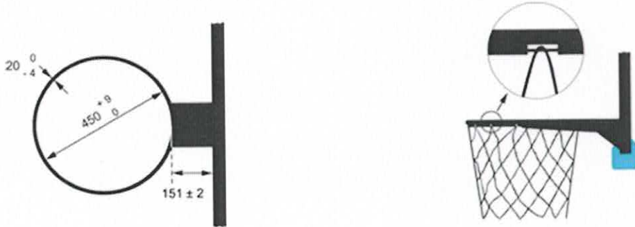
Çizim 8 Çember boyutları ve File Takılması
